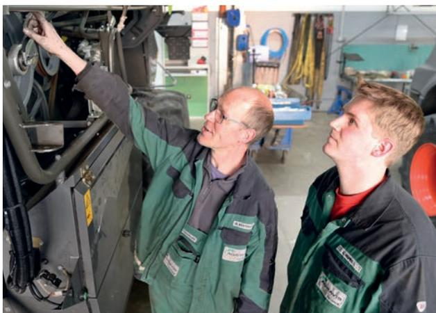
„Ich habe zum Beispiel beim Drescher alle Riemen entspannt und kontrolliert, ob sie rissig sind oder ob die Rollenlager funktionieren. Wenn nicht, dann wechsele ich das aus. Bei Wartungen an Dreschern oder Häckslern mache ich Ölwechsel oder erneuere die Entlüftungstopfen beim Getriebe.“
